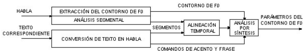
Figura 3. Extracción automática de los parámetros del contorno de F0 (Adaptada de Fujisaki y Ohno 1996).
